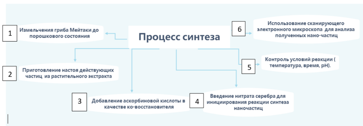
Рисунок 1. Процесс «зеленого» синтеза наночастиц серебра с помощью экстракта Мейтаке
